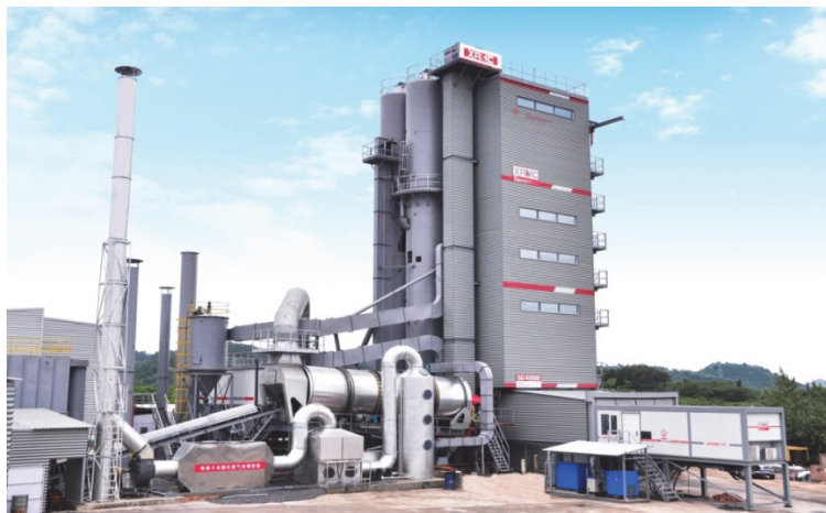
Рис. 1. Асфальтосмесительная установка компании CCCC XRMC (производства Китая) в комплектации с системой экологичного производства асфальтобетонной смеси
